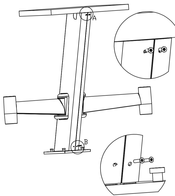
Fissare le viti VTSC316AF nella parte posteriore
