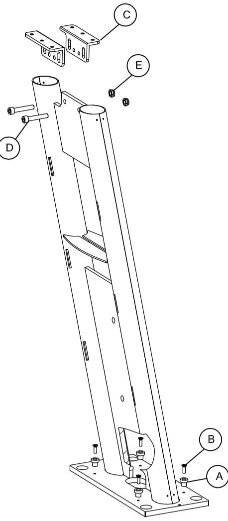
Fissare la struttura al pavimento. Le viti di fissaggio devono essere conformi al tipo di pavimento.
