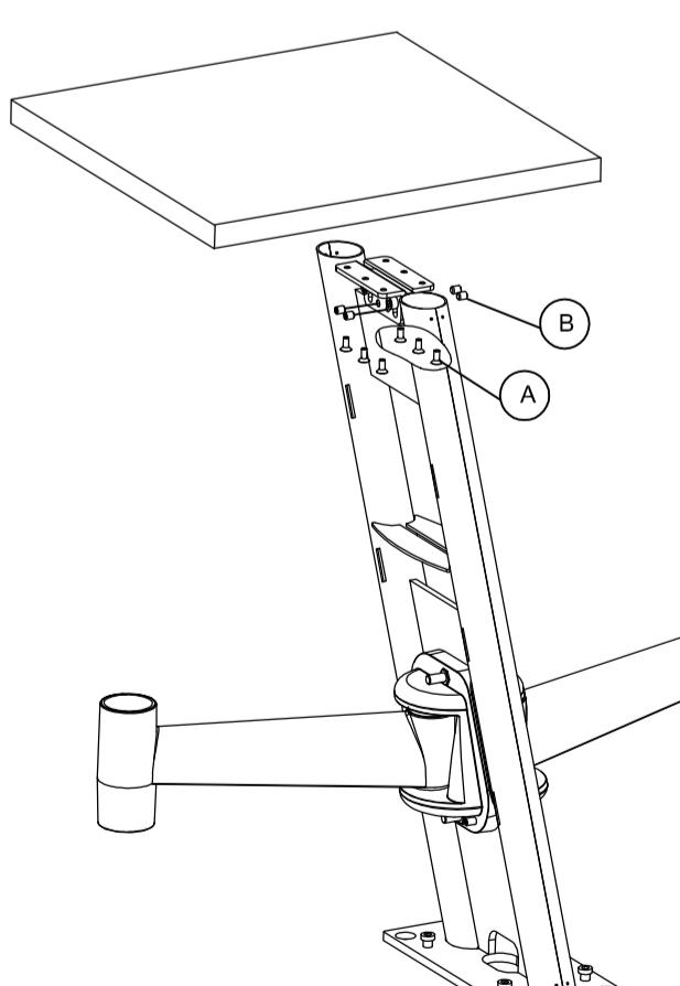
Fissare il piano con viti (A). Verificare la corretta posizione del piano e fissare le 2 viti VTCEI845Z (A). Per bloccare il piano fissare i grani VSTEI68 (B)
