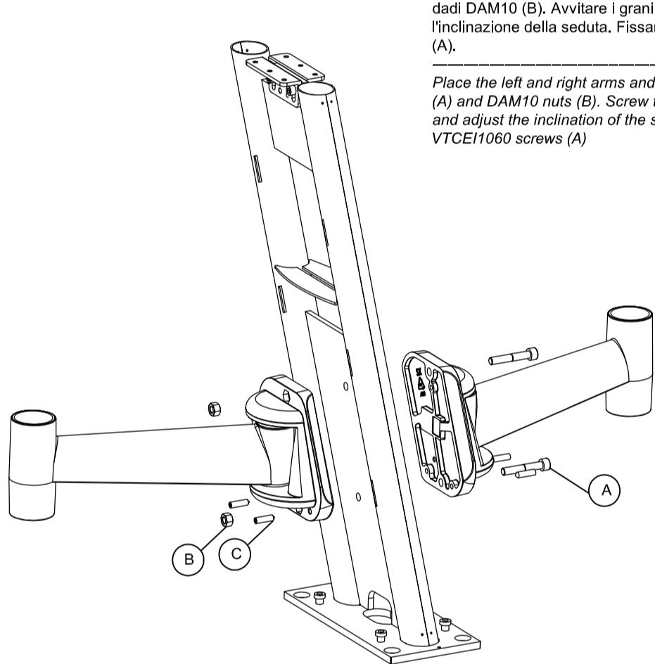
Posizionare i 2 bracci DX e SX e fissarli con le viti VTCEI1060 (A) e i dadi DAM10 (B). Avvitare i grani VSTEI825 (C) e regolare l'inclinazione della seduta. Fissare completamente le viti VTCEI1060 (A).
